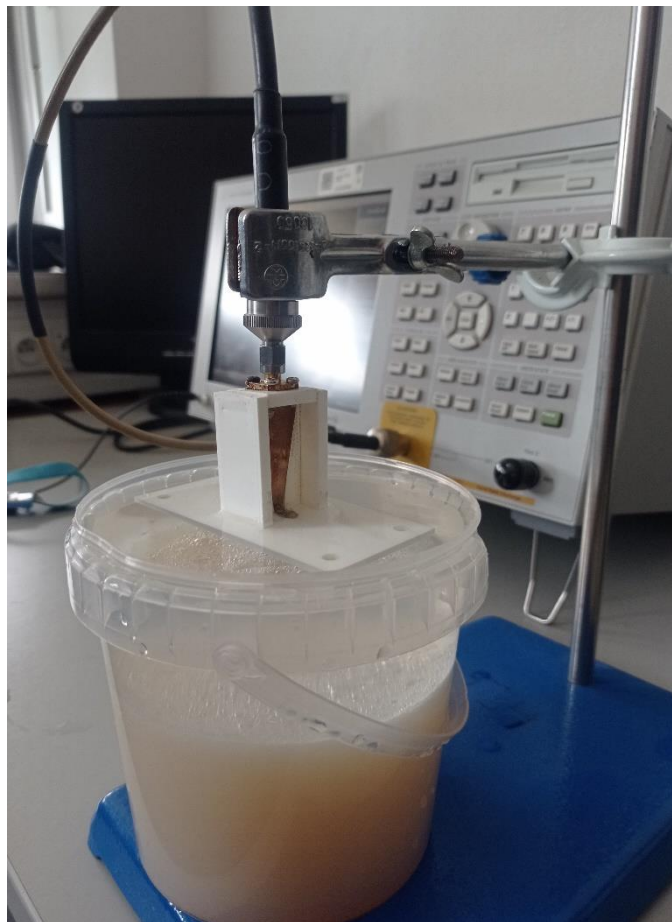
Obrázek 46: Testování Bow-tie antény s vodním bolem.
