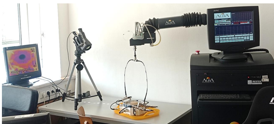
Obrázek 53: Sestava pro testování aplikátoru – vlevo IR kamera s monitorem, uprostřed dole aplikátor, uprostřed nahoře rameno s položeným vypojeným aplikátorem a zapojeným vodním bolem, vpravo hypertermický systém ALBA s mikrovlnným generátorem.
