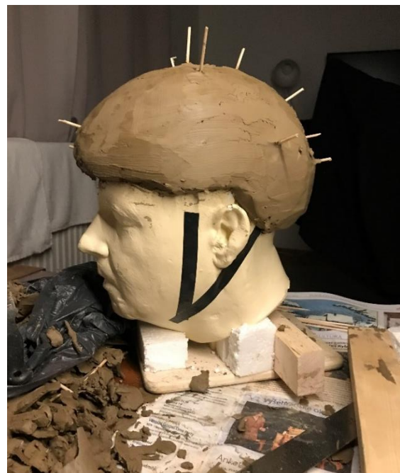
Obrázek 63: Měření tloušťky vrstvy v pohledu z boku
