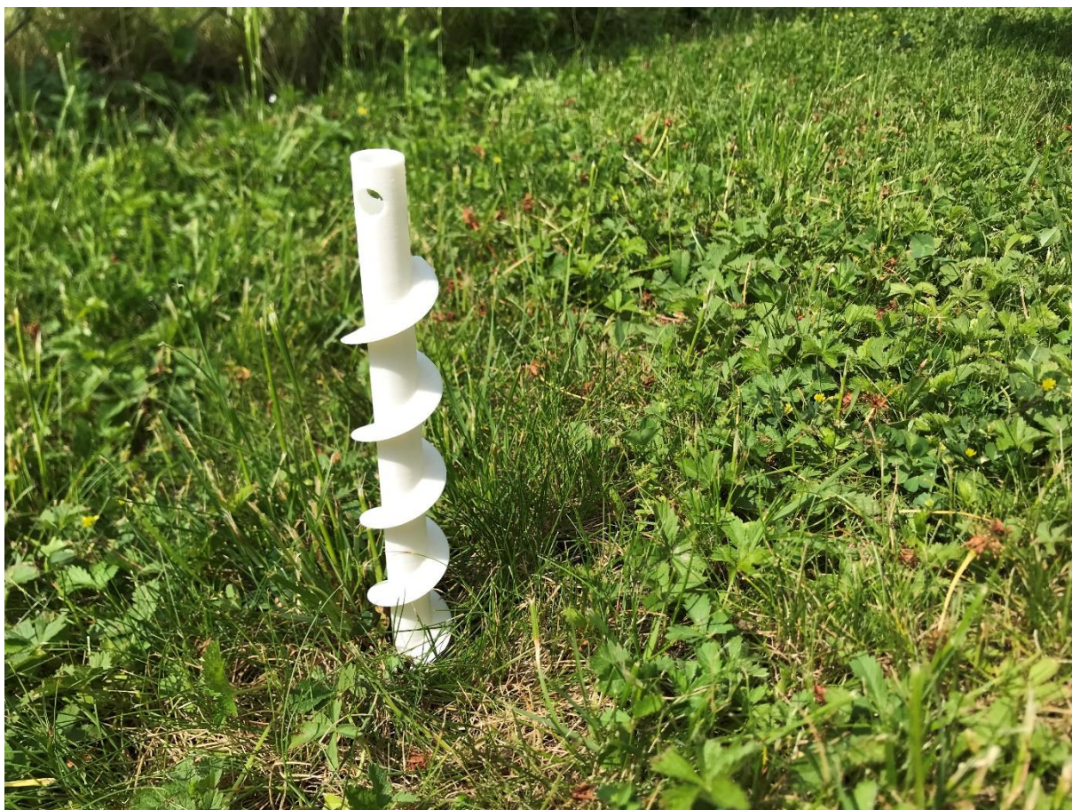
Obr. 22: Prototyp kolíku z 3D tisku
