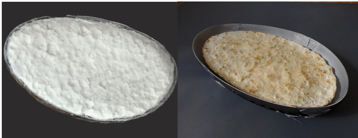
Obr. 103: Prorostlý panel připravený k inkubaci
