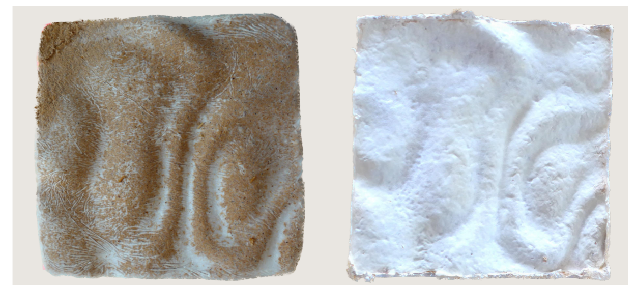
Obr. 51: Výrobek před a po inkubaci při vyjmutí z formy
