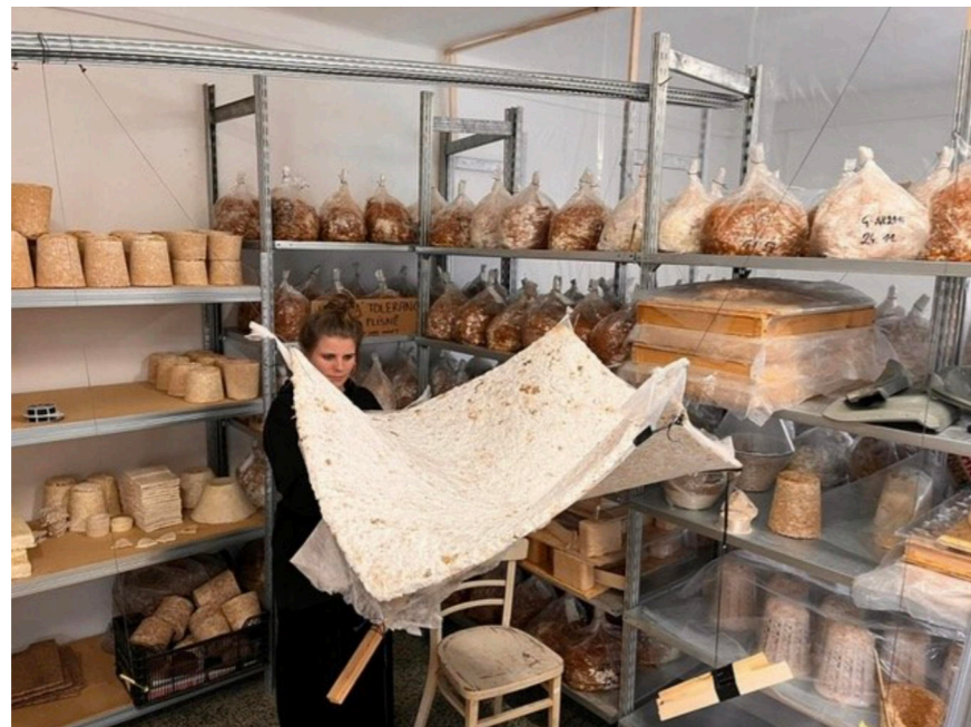
Obr. 20: Tvarování zavěšením ve firmě Mykilio
