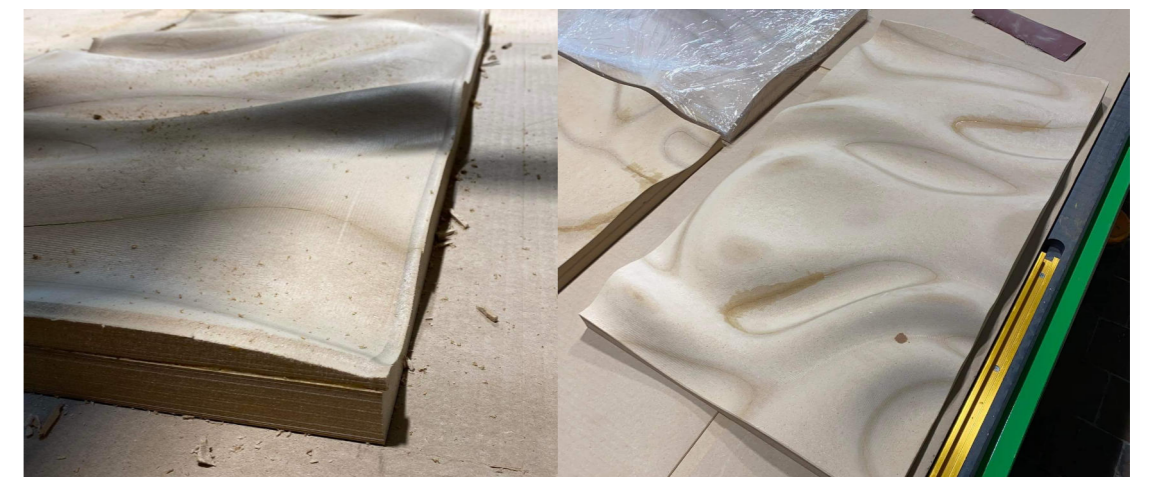
Obr. 94: Výroba forem technologií CNC z MDF
