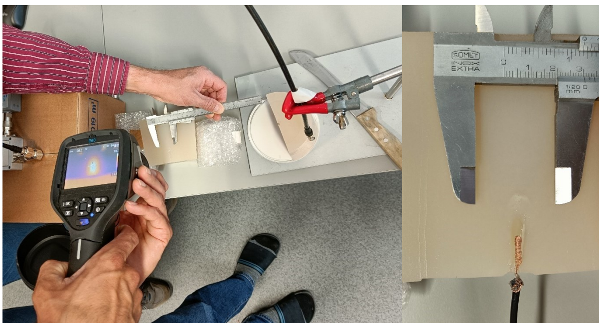
Obrázek 4.6 Fotodokumentace měření termogramu pomocí termokamery a ukázka oblasti, která by měla být zahřívána aplikátorem, pomocí posuvného měřítka. Na fotografii vpravo je viditelně roztavený agar po zahřívání.
