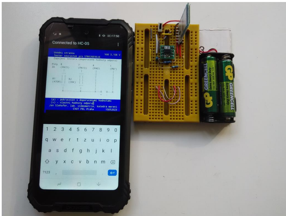
Obr. 56: Fotografie testeru provozovaného z baterie a komunikujícího přes Bluetooth.
