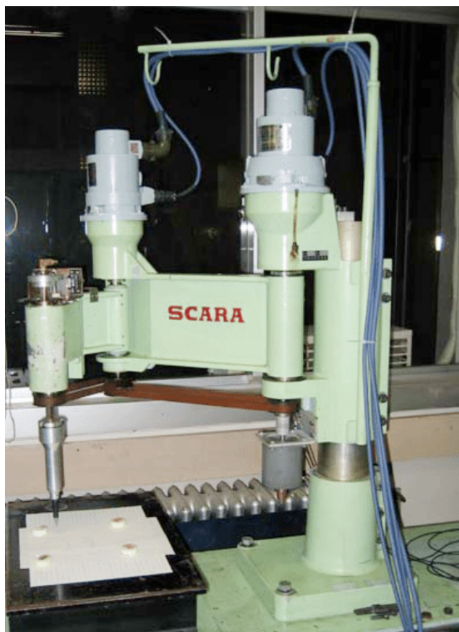
Obrázek 1.3: Jeden z prvních prototypů SCARA robota, který navrhl Hiroshi Makino.[2]
