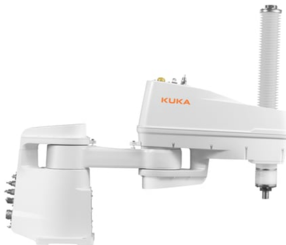
Obrázek 1.2: SCARA robotické rameno KR12 R750 Z340 CR od společnosti KUKA AG [5]
