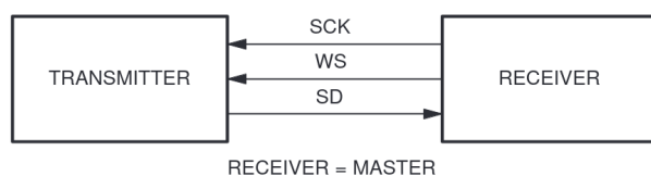
Obrázek 3.15: Ovládací zařízení master v roli přijímače. Převzato z [29].
