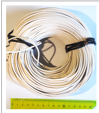
Obrázek 5.14: Měřená vzduchová cívka
