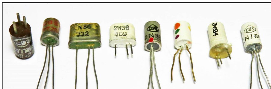
Obrázek 1.1. Sběrka bipolárních tranzistorů z roku 1953. Převzato z [3].
