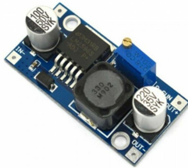
Obrázek 3.13. Step-down měnič LM2569 [34].
