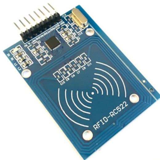
Obrázek 3.4. RFID modul RC522 [16].
