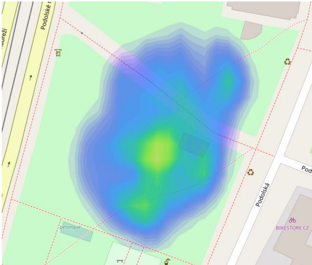
■ Obrázek 6.3 Vizualizace síly signálu sítě pomocí aplikace Heatmapper. Barevnost heatmapy odpovídá síle signálu, kde žlutá a zelená barva značí výsledky pod 70 dBm a modrá barva zobrazuje výsledky, které jsou vyšší než 70 dBm.
