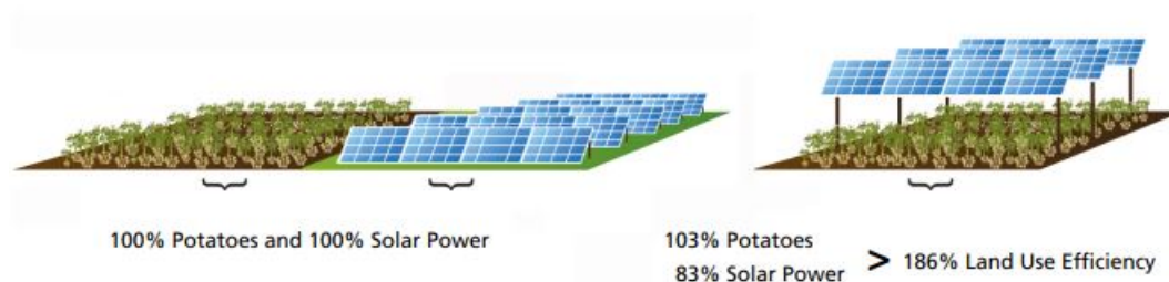
■ Obrázek 1.12 Názorná ukázka dvojího využití půdy. Konkrétní údaje jsou z roku 2018, kdy solární panely dokonce pomohly k větší úrodě brambor oproti roku 2017. Měření probíhalo v Heggelbachu v Německu.[10]
