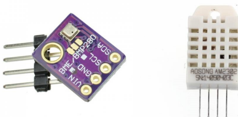
■ Obrázek 4.8 Senzory pro měření vlhkosti a teploty vzduchu. Nalevo je senzor BME280 a napravo senzor DHT22. Zmiňovaný senzor DHT11 vypadá totožně jako senzor DHT22. Zdroj: e-shop Drátek .
