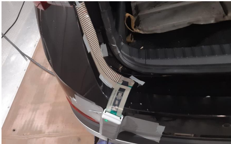
Obrázek 29: Umístění senzoru při měření zatížení v bočním směru
