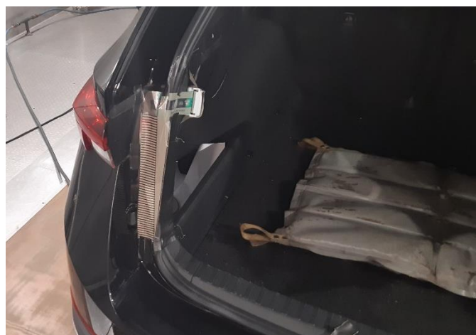
Obrázek 28: Umístění senzoru při měření zatížení v podélném směru
