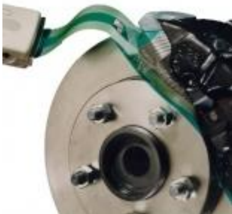
Obrázek 8 (vlevo): Měření rozložení tlaku v brzdových destičkách [11]
