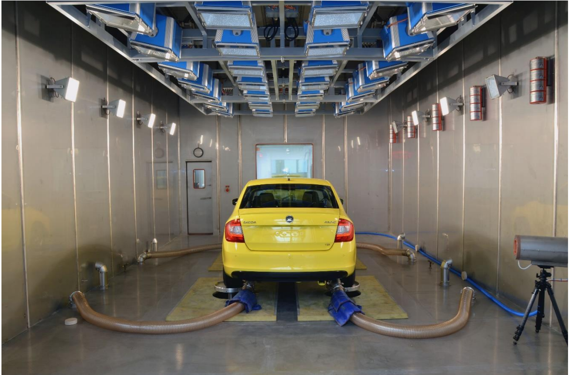
Obrázek 2: Zkušební vozidlo na 4 kanálovém simulátoru vozovky [4]
