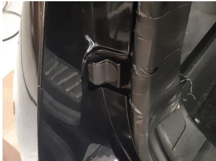
Obrázek 27: Dolní doraz se stáhnutým těsněním
