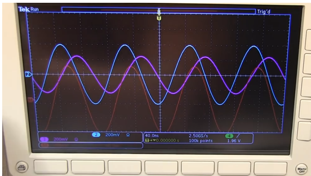
Obrázek 2.5: Signály I (modrý) a Q (fialový) a jejich vektorový součet (červený), znázorněny na osciloskopu.[10]
