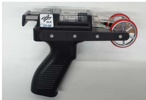
Zařízení Bioprinter FirstAid. Zdroj - OHB
