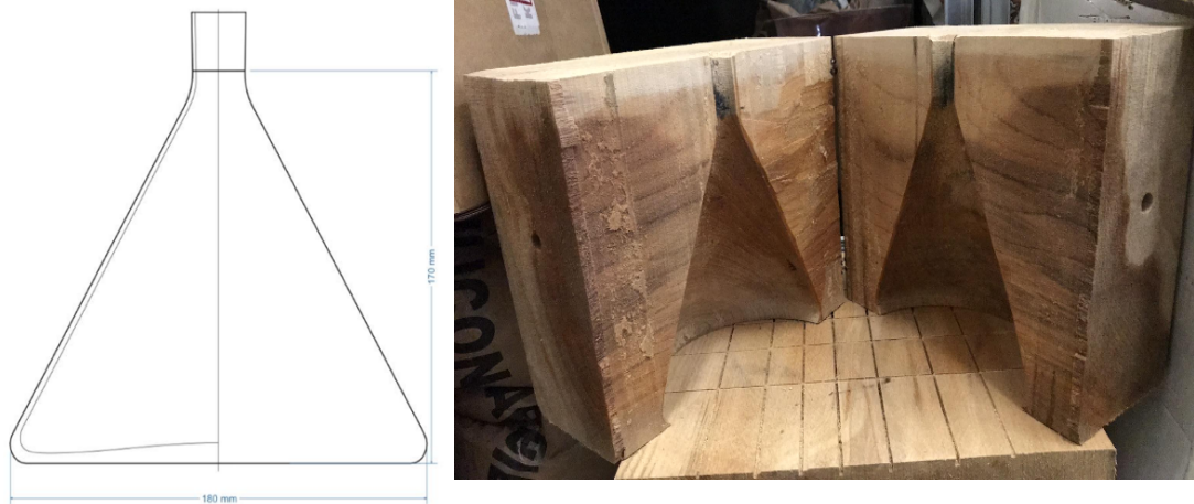
Obrázek 20: Návrh formy a její realizace
