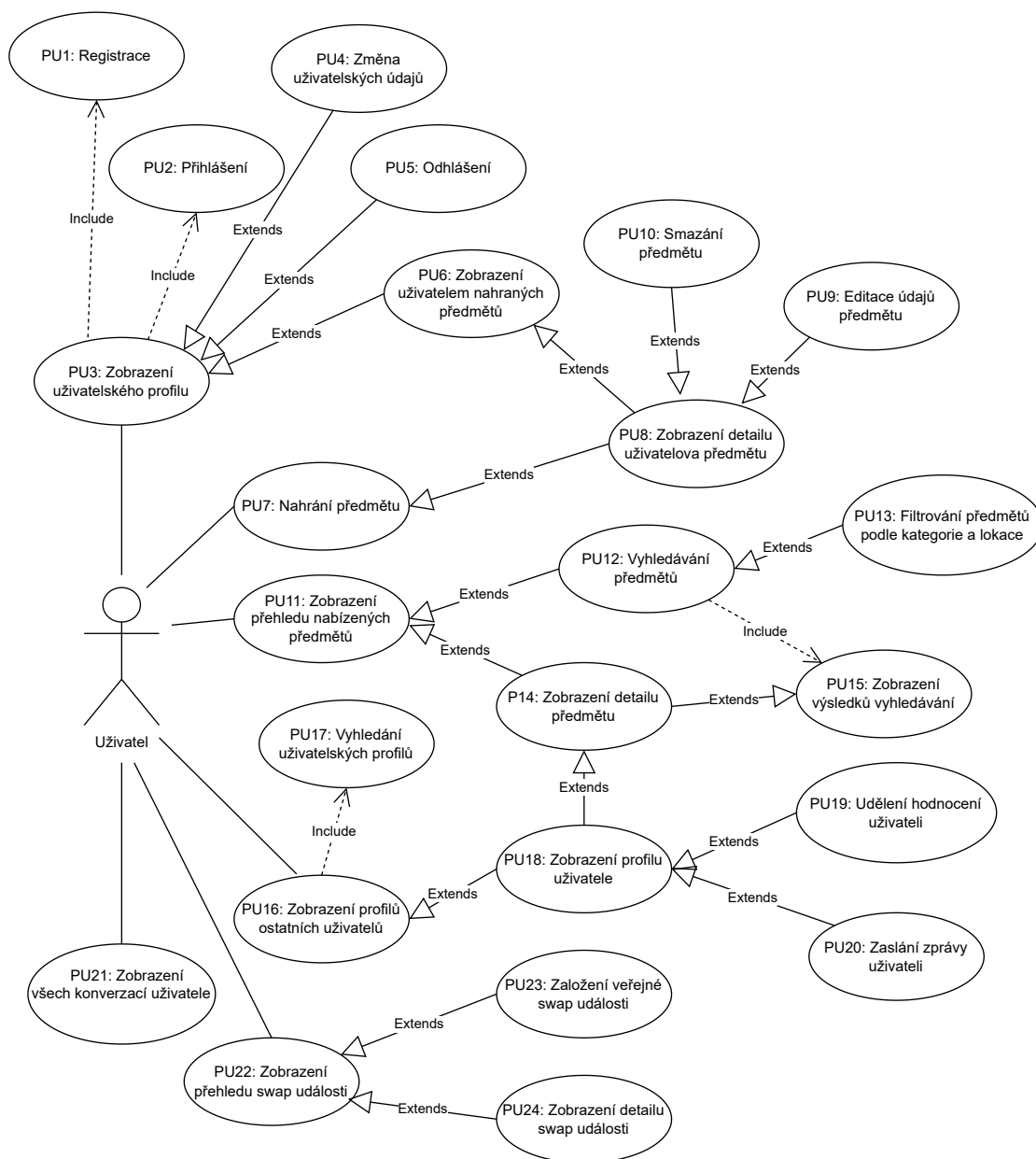
■ Obrázek 1.6 Diagram případu použití.
