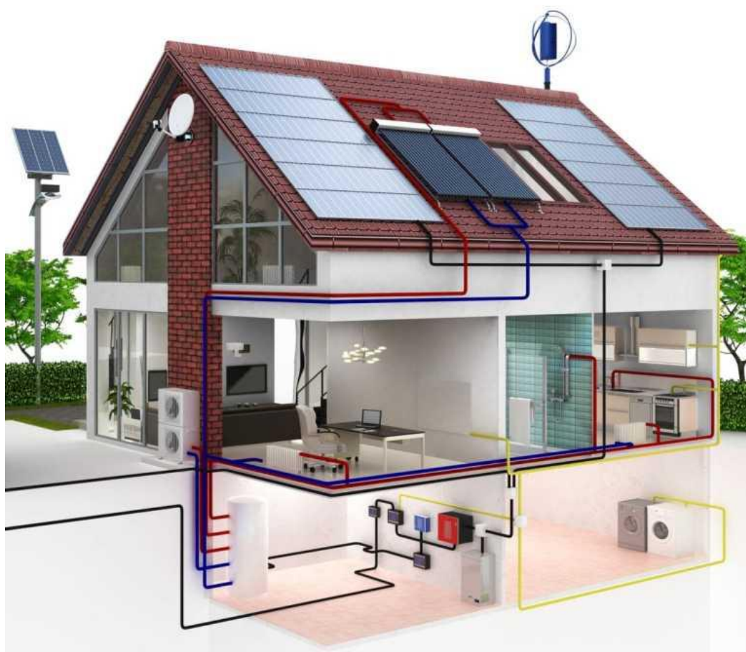
Obrázek 11: Schéma FVE + TČ
