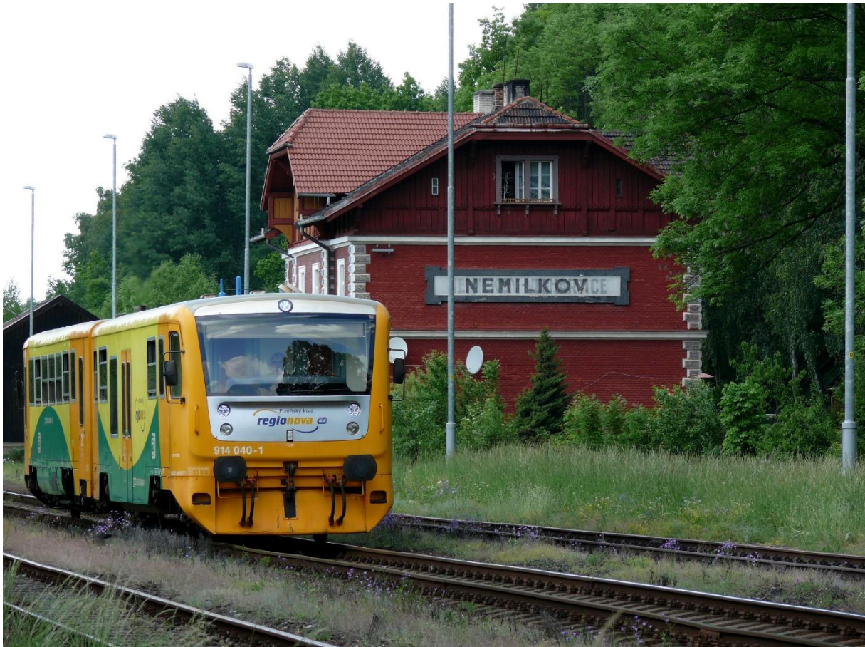
Obrázek 32: Motorová jednotka ve složení řídicí vůz řady 914 CZ a motorový vůz řady 814 CZ v ŽST Nemilkov
