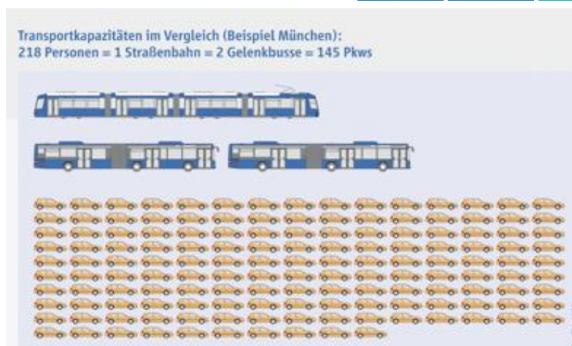
Obrázek 12 Porovnání 218 cestujících = 1 tramvaj = 2 kloubové autobusy = 145 osobních automobilů [16]
