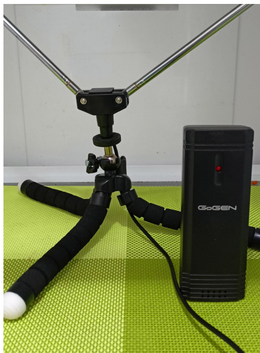
■ Obrázek 5.5 Zařízení připravené na odposlech a analýzu bezdrátového teplotního senzoru v izolovaném prostředí.
