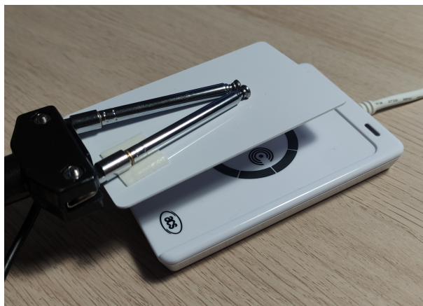
Obr. 2.24: Konfigurácia dipólovej antény s najlepšimi výsledkami. Foto autor
