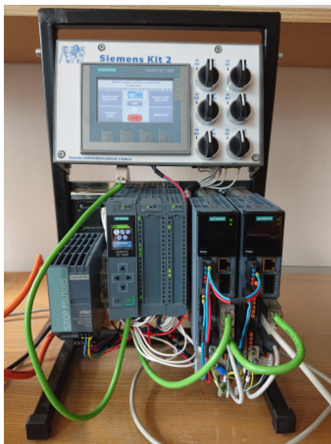
Obrázek 3.1. Přípravek se všemi přístroji a ovládacím panelem
