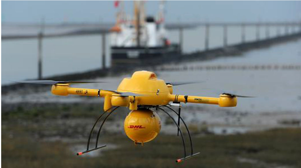
5 Doručovací dron Parcelcopter 2.0 Microdrones Md4-1000 (90)
