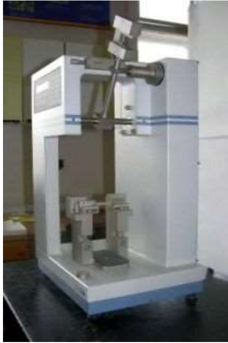
Obr. 3-3 Přístroj na měření vrubové houževnatosti RESIL 5.5 od výrobce Ceast
