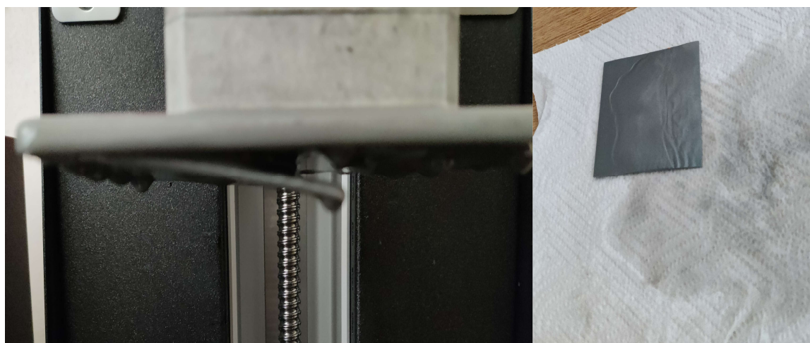
Obr. 3-1 Ukázka chyby při tisku vzniklé kvůli nedostatečné přilnavosti vzorku k podložce
