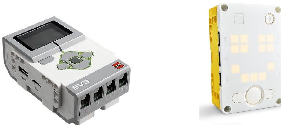
Obrázek 4.1: Porovnání hubů EV3 a Spike Prime. [1], [7]
