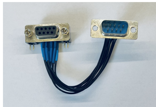
(b) Přečodka konektoru DB9
