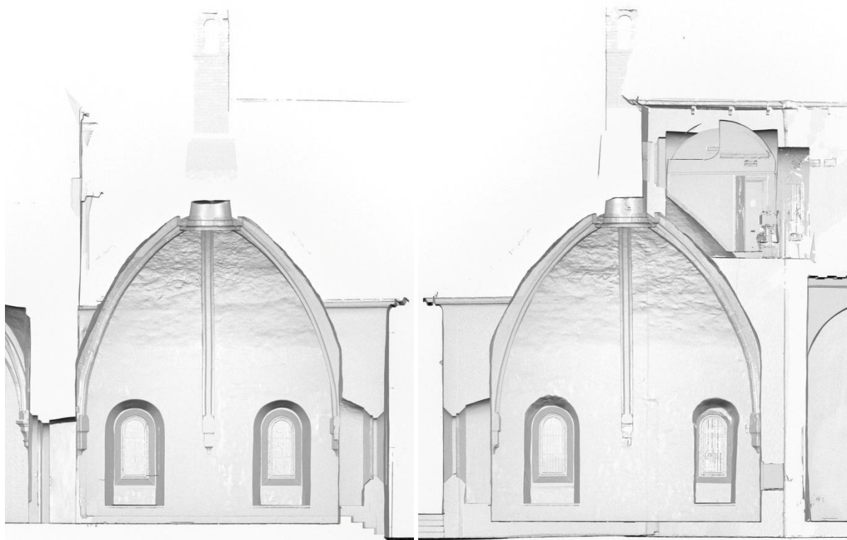
Obr. 4: Jižní a východní stěna kuchyně. Řezopohled, 3D scan kuchyně. Cejpvá a kol. 2019-2020, 3D scan zpracoval J. Šedina. Upraveno.
