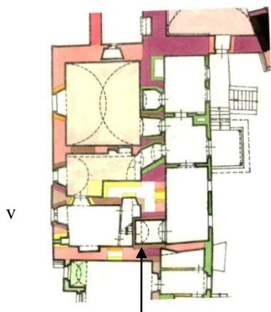
Obr. 9: Konzola podpirající pas v prostoru kuchyňky, která je součástí obchodu. Kuchyňka je vložena do prostoru vybouraného v hradbě
