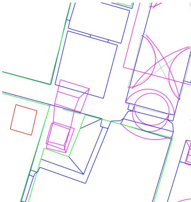
Obr 51: Kuchyně 3. Komín kuchyně 3 v prostoru půdy je zakreslený fialovou barvou. Zaměření hradu, upraveno. Výřez ze zaměření hradu.
