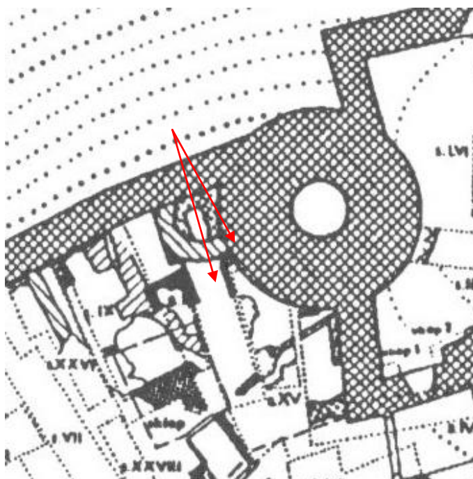
Obr. 2: Půdorys kuchyně. Legenda: 1 - západní obvodové zdivo kuchyně, čárkovaně - dochované jen v negativu, 2 - prostor topenišť, 3 - obvodové zdivo topenišť, dochované jen v negativu, 4 - interiér pece, 5 - bergfrit, 6 - severní obvodová hradba, 7 - pozůstatek vstupní šije, dochované jen v negativu, 8 - východní dochované obvodové zdivo kuchyně. Podle Durdík 1987, 356.
