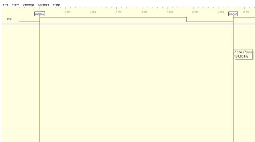
Obr. 4-2 Detail intervalu pulzně šířkového řízení jasu
