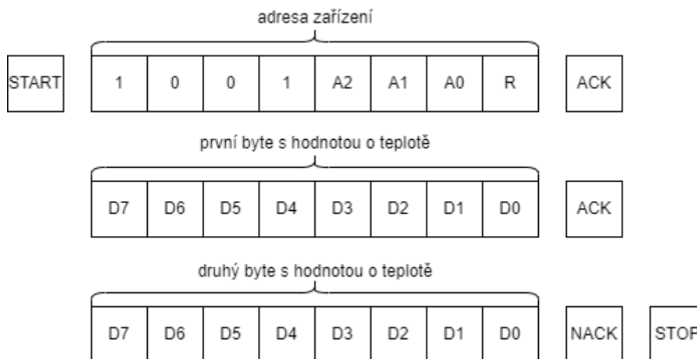
Obr. 3-22 I2C – přenos hodnoty teploty
