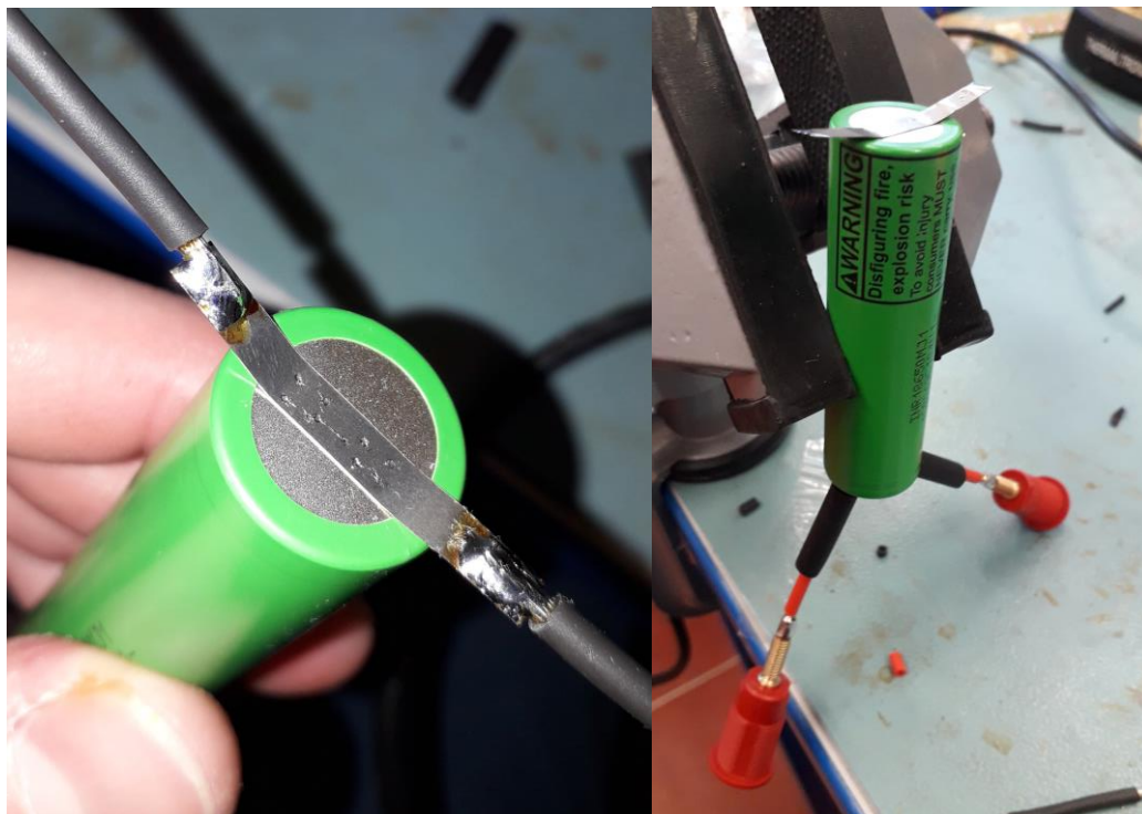
Obr. 6-2 Navařený niklový pásek a k němu připájené vodiče na záporném pólu článku (vlevo). Pohled na přípravu článku (vpravo)
