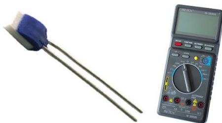
Obrázek 5.1: Použité teplotní platinové odporové čidlo Pt1000 zapojené s multimetrem Metex M-3850 v režimu měření odporu. Optimální metodou by byla kalibrace pomocí 4-vodičů na trojný bod/bod varu, protože poskytuje vyšší přesnost a minimalizuje vliv odporu vodičů. Nicméně z důvodu časových omezení byla pro tato měření zvolena jednodušší dvouvodičová metoda.
