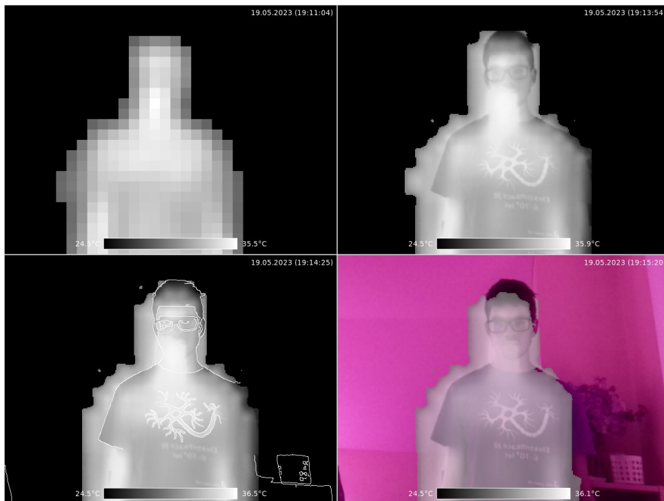
Obrázek 4.7: Zobrazení jednotlivých typů výstupu, které nabízí uživatelské rozhraní. Vlevo nahoře je zobrazen nezpracovaný výstup MLX kamery po aplikaci předzpracování na vstupní data (viz kapitola 3.1). Napravo je pak prezentován zpracovaný výstup pomocí BSD algoritmu (viz kapitola 4.4.4). Vlevo dole je zobrazován zpracovaný výstup doplněný o hrany, které byly získány z RGB snímku pomocí funkce OpenCV Canny . Obrázek vpravo dole zobrazuje interaktivní výstup, ve kterém jsou výstupní data algoritmu BSD kombinována s výstupem z RGB kamery s nastavenou mezí teploty a procentuálním překrytím. To určuje kolik procent termogram zaujímá vzhledem k obrázku z viditelné části spektra. Tohoto výsledku bylo dosaženo pomocí funkce OpenCV addWeighted
