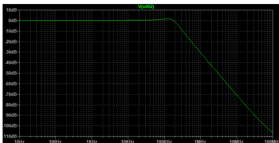
Obrázek 6.3: Frekvenční charakteristika použitého vstupního filtru.
