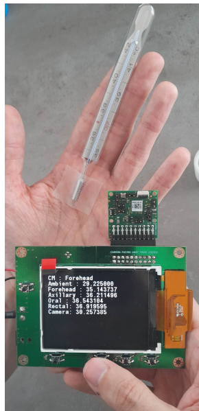
Obrázek 6.17: Kalibrace měření povrchové teploty pomocí lihového teploměru.
