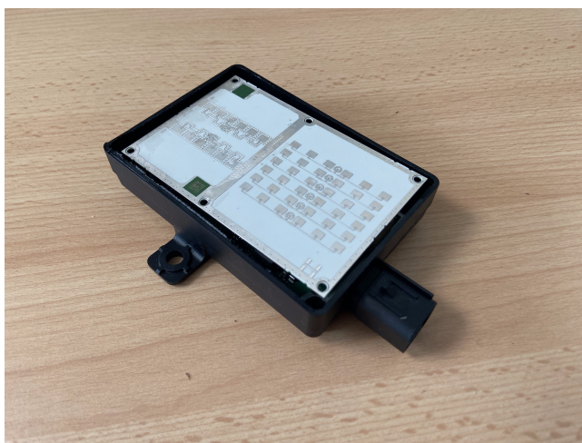
Obrázek 3.15: Automotive radar, 24 GHz
