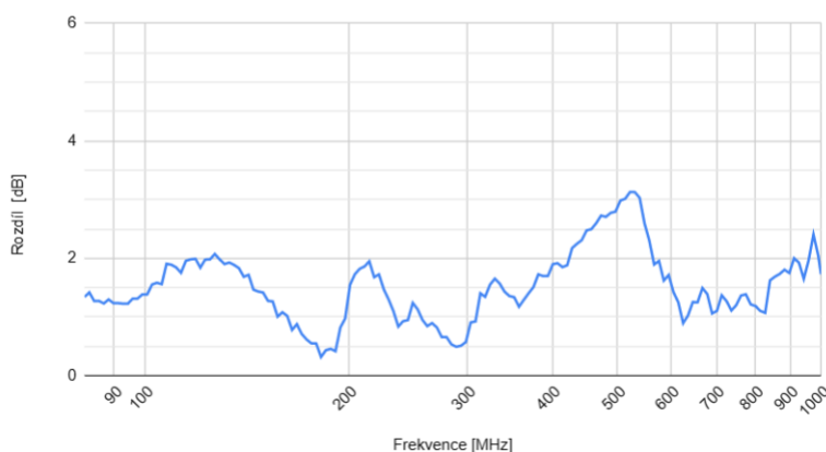
Obrázek 3.5: Kolísání síly pole uvnitř homogenní oblasti [80 MHz - 1000 MHz]
