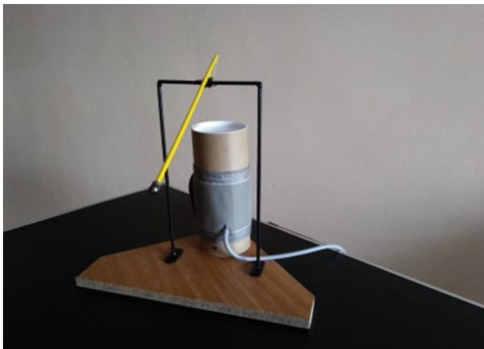
Obrázek 5.7: Mechanické kyvadlo pro vytvoření jednotkového impulsu na pneumatický systém. [21]
