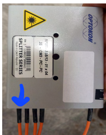
Obrázek 5.1: Použitá rozbočnice s označením použitého výstupu. Na obrázku vlevo jsou 4 výstupy samostatně vpravo je vstup.
