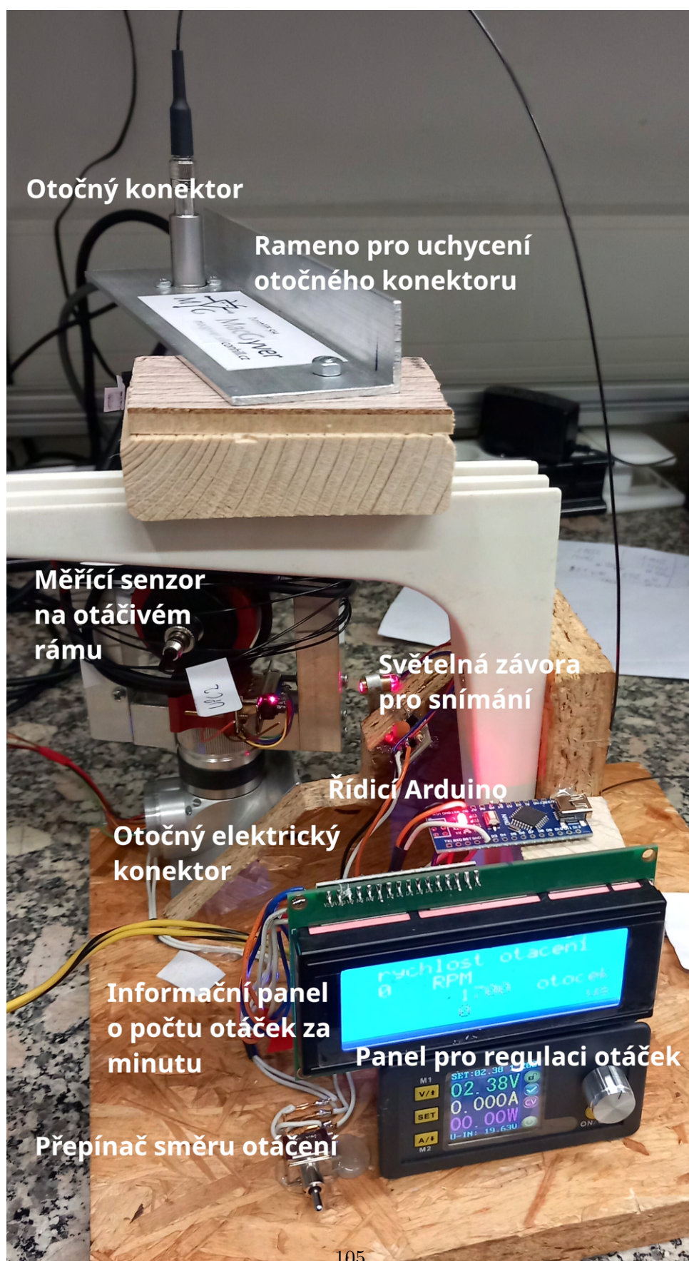
Obrázek 5.24: Fotografie zařízení s otočným konektorem SPINNER (přípravek pro testování otočného konektoru byl vyroben v rámci disertační práce ing. Petra Martinka).
