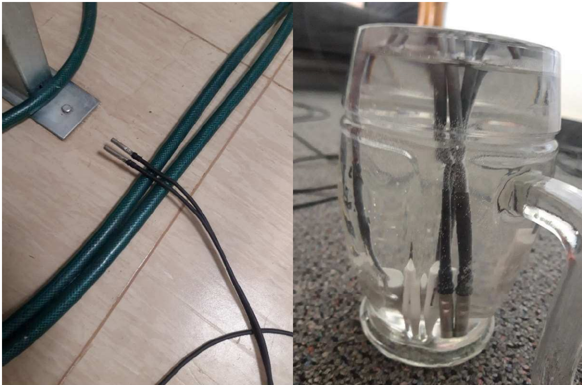
obr. 32 – Stabilizace teplotních čidel a kontrola odchylky
