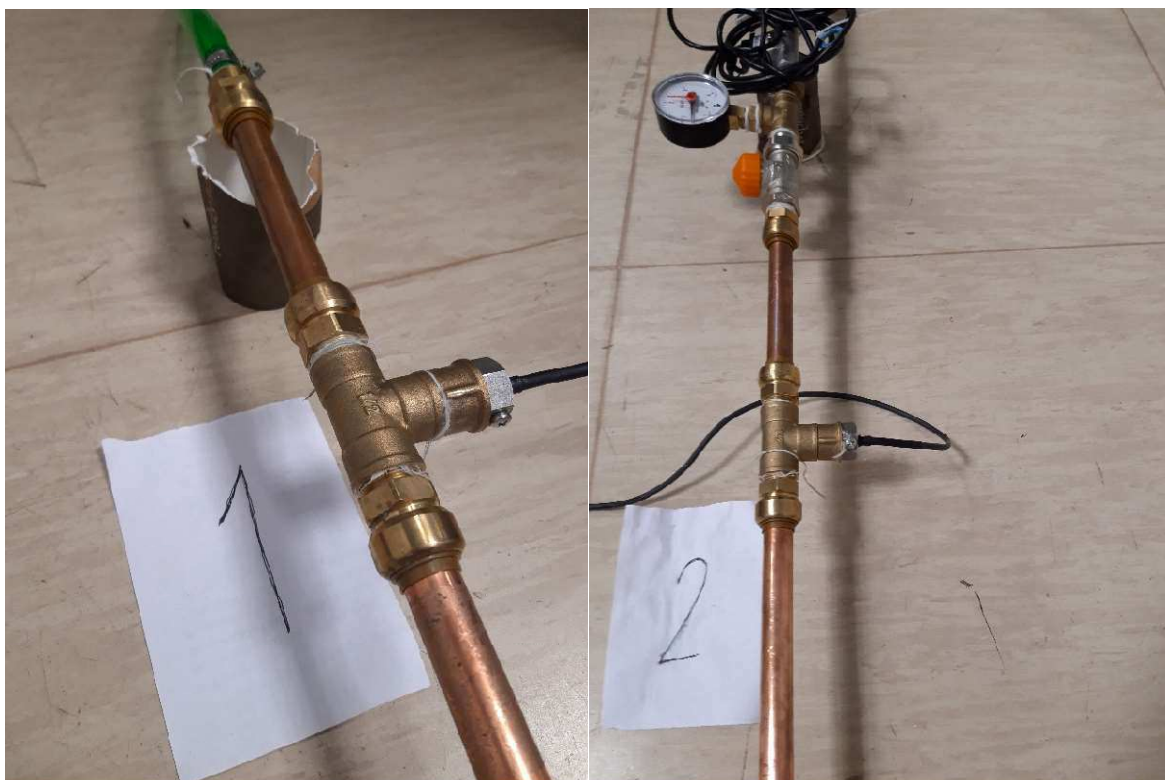
obr. 28 – Foto jímek s ponornými čidly teplot pro odběr hodnot T_z (č. 1) a T_k (č. 2)
