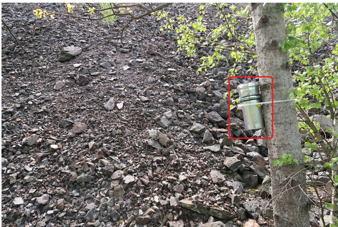
Obr. 2.6: Sonda v ochranném krytu umístěná na stromě u paty odvalu (foto: Jan Hradecký)
