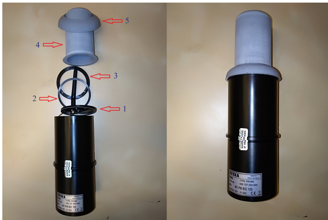
Obr. 2.8: Nová konstrukce sondy s těsnícími prvky (vlevo), složená sonda (vpravo)
