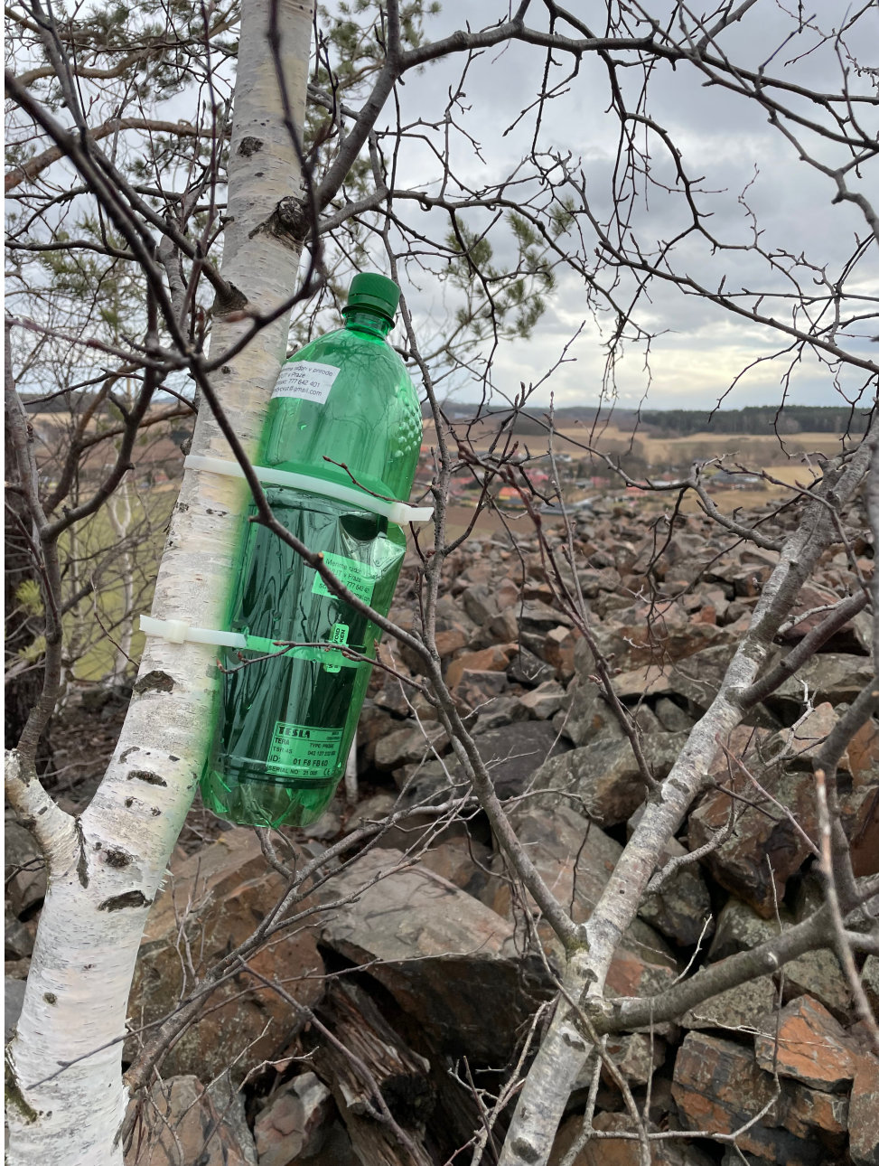
Obr. 2.12: Sonda umístěná v měřicím bodu „E“ opatřená ochranným krytem vyrobeným z PET lahve (foto: Václav Štěpán)
