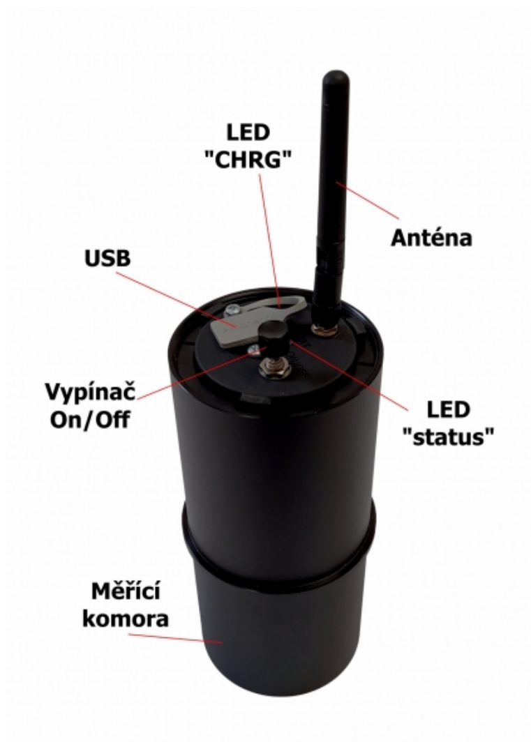
Obr. 2.1: Sonda TSR4S s popisem základních částí [56]
