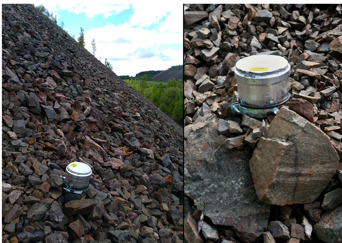
Obr. 2.7: Sondy v ochranných krytech umístěné v hlušině na stěně odvalu (vlevo) a v hlušině u paty odvalu (vpravo)
