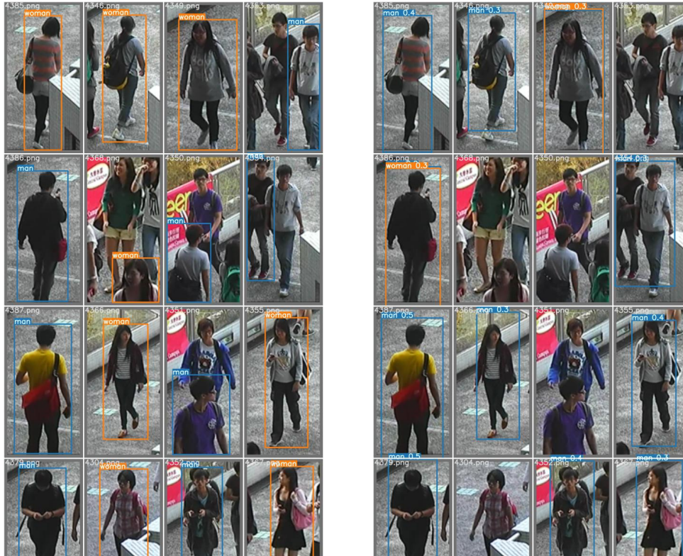
Obrázek 5.7: Vlevo máme správně anotované obrázky a vpravo predikci dotrénovanou sítí YOLOv7 na datasetu PETA
