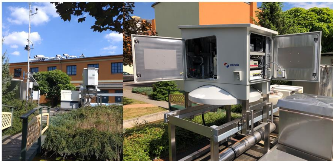
Obrázek 2.4-1 Upravený prototyp spektrometrického modulu s HPGe detektorem v areálu SÚRO Praha, 2021
