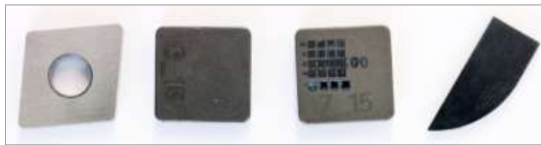
Obr. 33: Vzorky řezných materiálů pro měření pohltivosti laserového záření (zleva): SK (VBD: CNMA 120804), ŘK – S (VBD: SNGN 120804), ŘK – N (VBD: SNGN 120804), PKD (segment).
