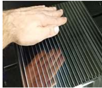
Obr. 85: Obrobený povrch vytvořený při modelových testech vyvíjeného prototypu nástroje.
