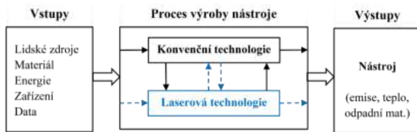
Obr. 63: Schematické znázornění procesu výroby nástroje s možnou implementací laserových technologií a jejich interakcí s konvenční výrobní technologií.
