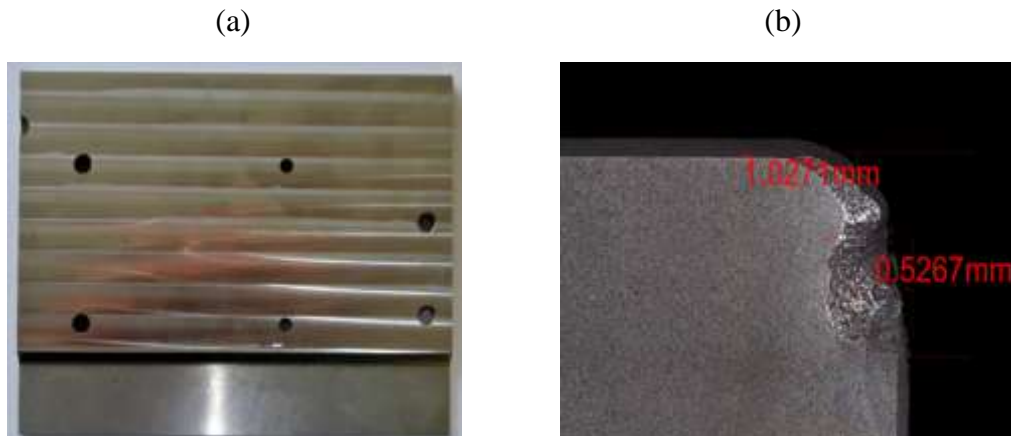
Obr. 86: Renovace kaleného povrchu střížníku: (a) stav povrchu po obrobení vyvinutým prototypem nástroje vyráběného s pomocí laseru (rozměr obrobené plochy 185 x 115 mm); (b) stav čela břitu nástroje na konci trvanlivosti.
