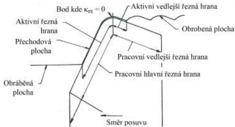
Obr. 2: Podoba a názvosloví řezné části nástroje s definovanou geometrií břitu dle [10].
