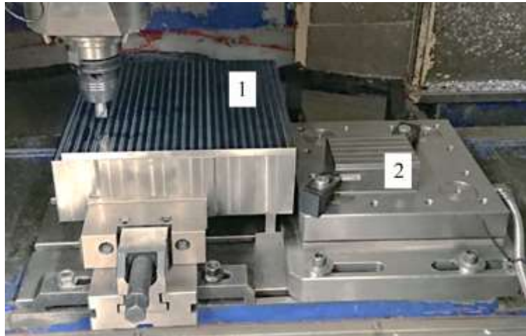
Obr. 80: Nastavení experimentu pro modelové testy frézovacích nástrojů z PKNB: 1 – testovací obrobek pro měření trvanlivosti břitu; 2 – obrobek ze stejného materiálu upnutý na dynamometru pro měření silového zatížení.
