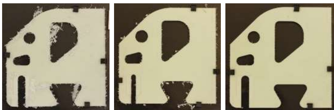
Obr. 76: Porovnání kvality vybraných dílců z hlediska plochy delaminace (zleva): Standardní nástroj; Konkurent 2; Vyvíjený prototyp.
