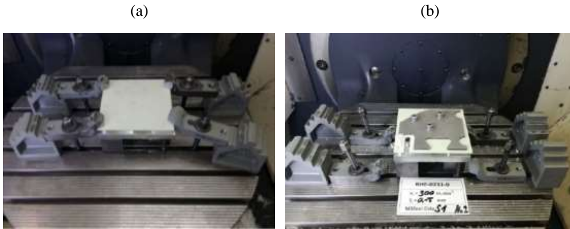
Obr. 74: (a) Příprava dílce a jeho upnutí na obráběcím stroji: (a) první operace – výroba vnitřních prvků; (b) druhá operace – dokončení dílu výrobou vnějších prvků. [146]
