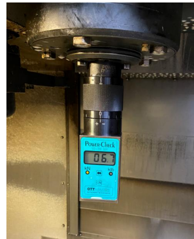
Obr. 36: Měření up. síly pomocí měřidla Power Check [252]
