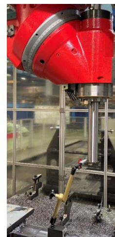
Obr. 33: Ukázka měření házivosti vřetene úhlové hlavy [252]
