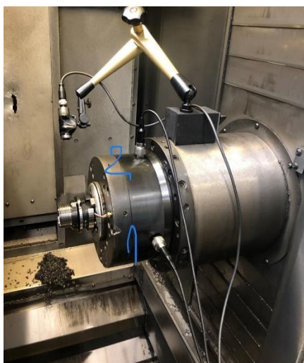
Obr. 138: Foto typu vřetena s umístěním měřicího místa a charakteristika pohonu vřetene
