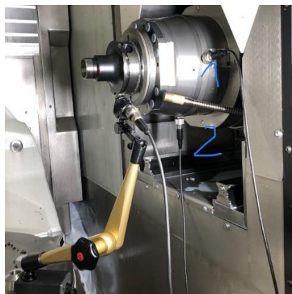
Obr. 92: Foto typu vřetena s umístěním měřicího místa a charakteristika pohonu vřetene
