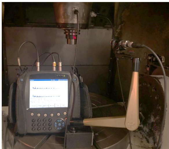
Obr. 89: Analyzátor vibrací SKF Microlog a snímače vibrací umístěné na přední části měřeného vřetene
