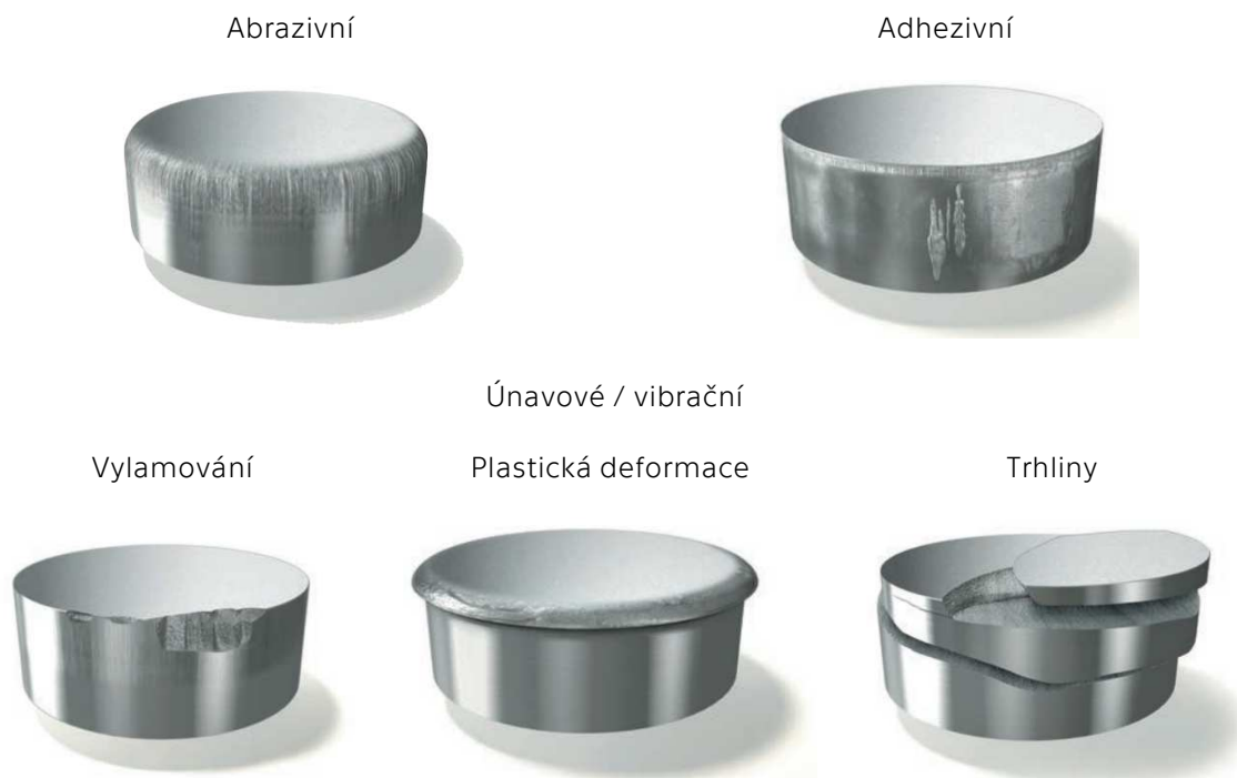
Obr. 47. Typy obvyklého poškození nástrojů pro práci za studena [98].
