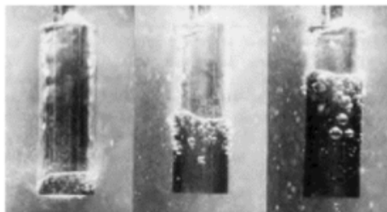
Obr. 34. Průběh odtržení parního polštáře vzniklého během kalení do 30 °C vody válečku z chrom-niklové oceli o průměru 25 mm a výšce 100 mm [65]
