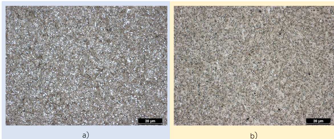
Obr. 63. SM, 2 % Nital, a) ASP 2023, 1050 °C, 540 °C/ 520 °C/ 520 °C, b) ASP 2005, 1050 °C, 540 °C/ 520 °C/ 520 °C
