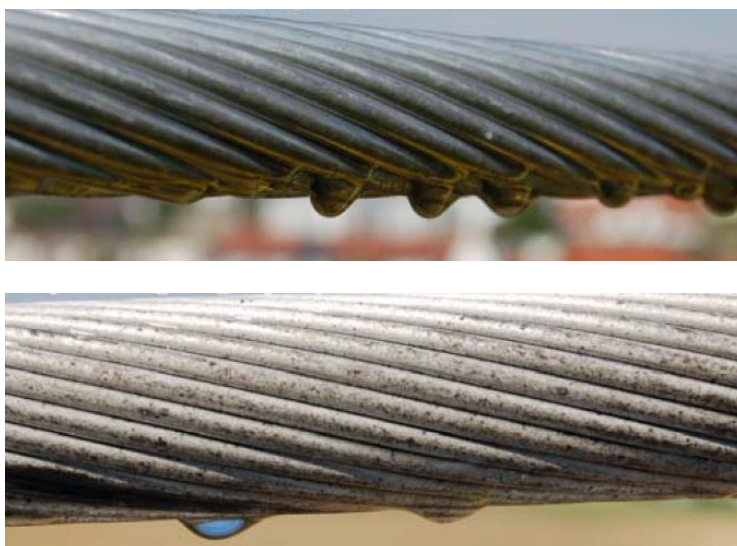
Obrázek 8.3: Efekt stárnutí vodiče po 10 měsících a 25 letech [39]
