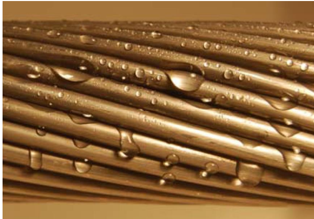
Obrázek 8.1: Kapky na povrchu nového fázového vodiče
