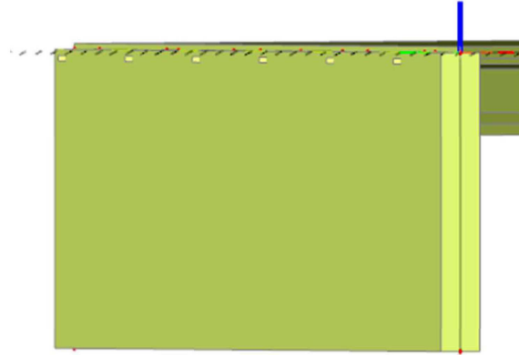
Obr.6.2: Opěra vymodelovaná pomocí stěny [vlastní tvorba]
