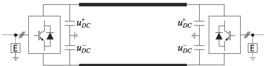
Obrázek 2.2: Blokové schéma symetrické monopolární konfigurace [6]
