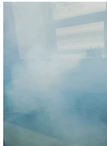
obr. 65 - Stav požadované koncentrace kouře v CHÚC
