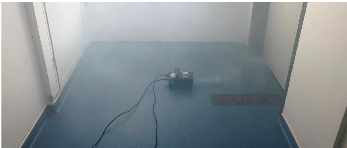
obr. 75 – Poloha kouřového generátoru po přemístění do bezprostřední blízkosti před vstup do CHÚC
