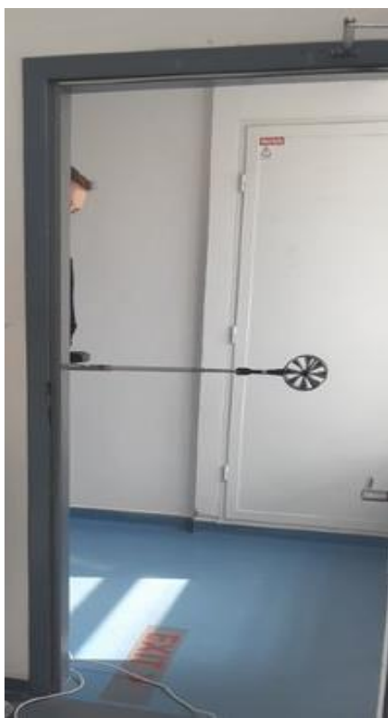
obr. 39 - Průběh měření rychlosti proudění vzduchu skrze otevřené dveře ve 4.NP
