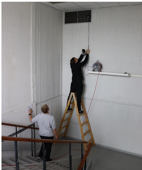
obr. 47 – Průběh měření rychlostí proudění na stěnové vyústce ve 13. NP
