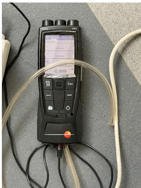
obr. 36 - Použitý kalibrováný manometr Testo 480 pro měření rozdílu tlaků
