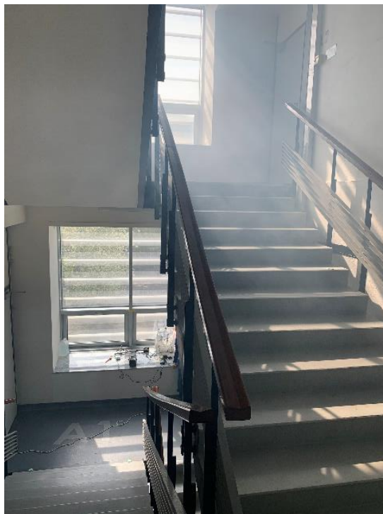
obr. 66 - Pohyb kouře směrem k odvodnímu prvku
