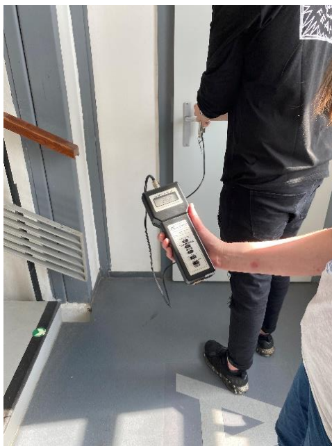
obr. 38 - Průběh měření síly potřebné k otevření dveří ve 3.NP
