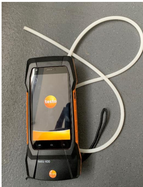
obr. 43 - Použitý univerzální přístroj pro měření klimatických veličin Testo 400
