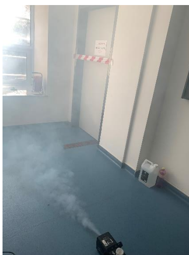
obr. 71 - Spuštění kouřového generátoru v blízkosti před vstupem do CHÚC v 1. NP
