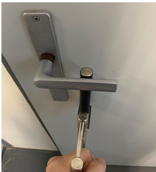
obr. 84 – Průběh měření síly potřebné k otevření dveří
