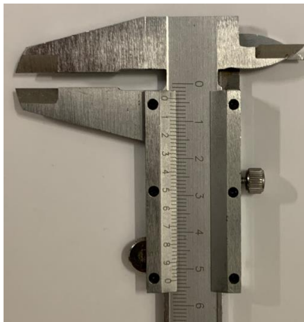
obr. 107 – Hodnota šířky horizontální lamely natočené v kolmém směru na rovinu vyústky
