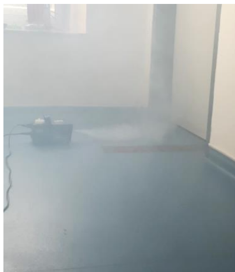
obr. 77 – Proudění kouře v bezprostřední blízkosti před vstupem do CHÚC
