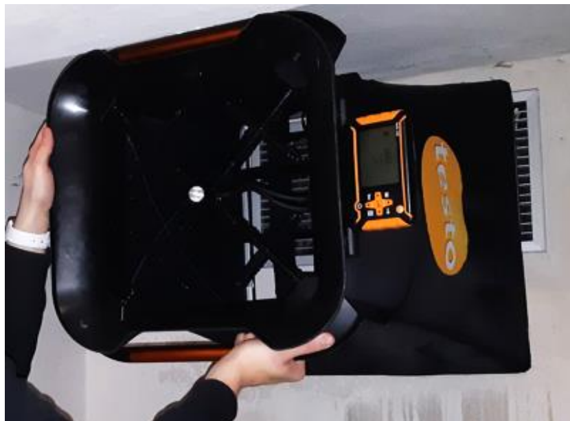
obr. 58 – Příklad přístroje pro měření objemového průtoku Testo 420 s integrovaným usměrňovačem proudění
