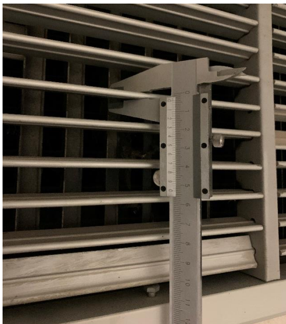
obr. 106 – Průběh měření šířky horizontálních lamel natočených v kolmém směru na rovinu vyústky
