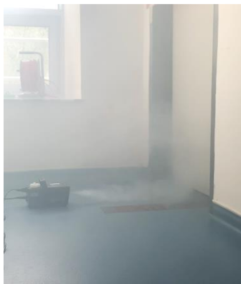
obr. 78 – Proudění kouře v bezprostřední blízkosti před vstupem do CHÚC
