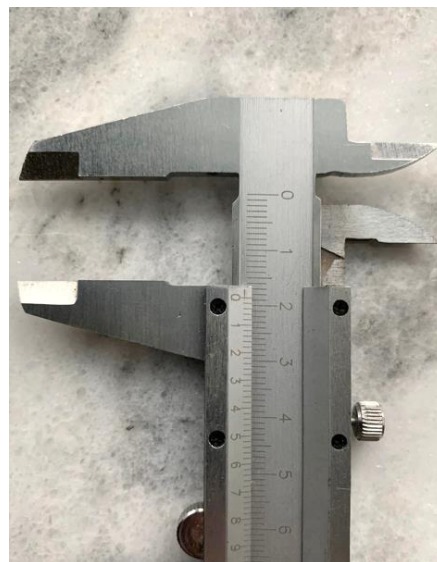
obr. 70 – Hodnota netěsnosti 19 mm naměřená na kouřotěsné dveřní sestavě v 1. NP
