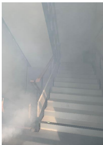
obr. 64 - Průběh akumulace kouře v CHÚC
