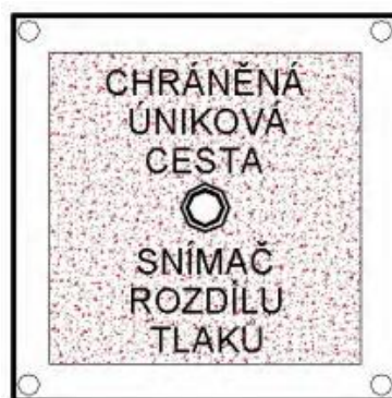
obr. 19 - Doporučené označení snímače rozdílu tlaků [25]
