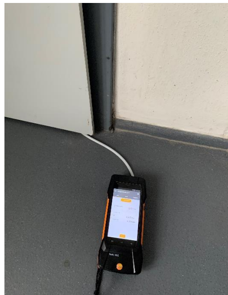
obr. 44 - Průběh měření rozdílů tlaků v 1. NP
