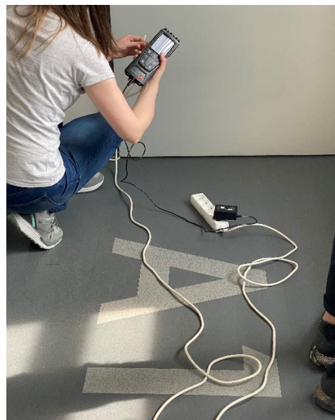
obr. 37 - Průběh měření rozdílu tlaků v 1. NP
