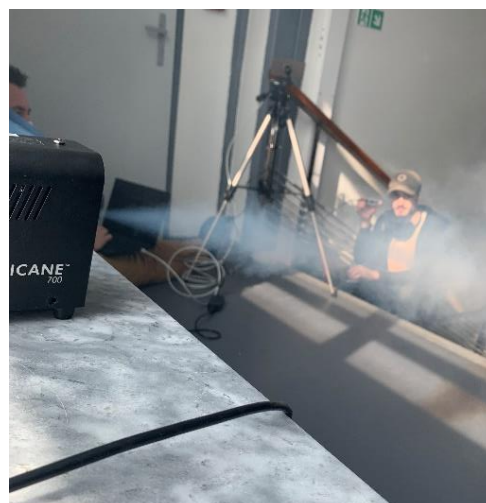
obr. 62 - Netoxický kouř vyvíjený z kouřového generátoru
