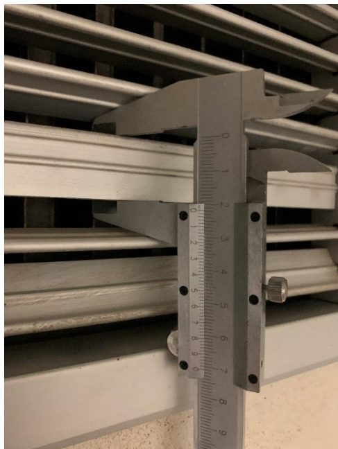
obr. 108 – Průběh měření šířky horizontálních lamel natočených v rovnoběžném směru s rovinou vyústky
