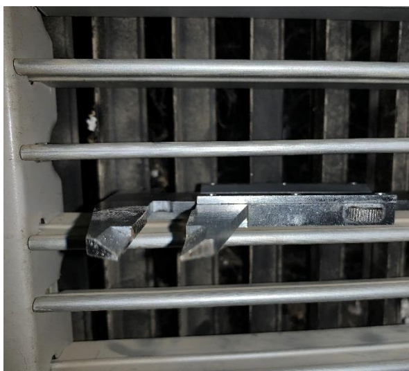
obr. 101 – Průběh měření šířky výtokové plochy mezi lamelami s vertikálním uspořádáním na vyústce typu A
