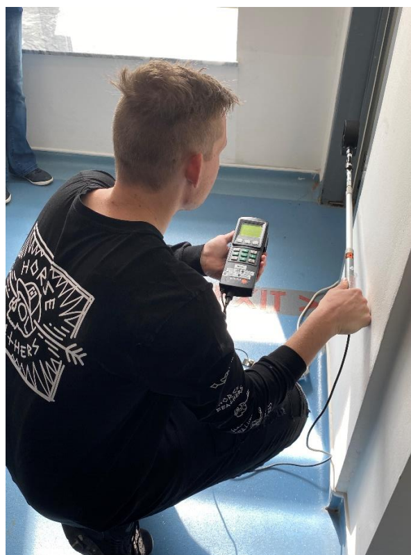
obr. 40 - Průběh měření rychlosti proudění vzduchu skrze otevřené dveře v 1.NP
