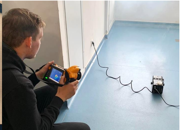
obr. 80 – Průběh sledování teploty kouře
