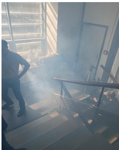
obr. 63 - Koncentrace kouře po spuštění kouřového generátoru
