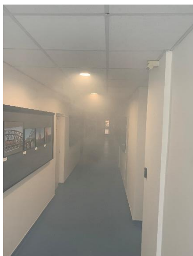
obr. 72 - Průběh akumulace kouře na chodbě v 1. NP
