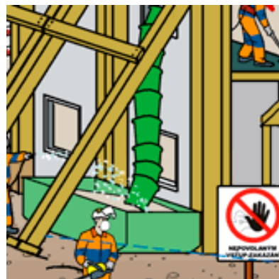
Obr.32: Uzavřený shoz (Převzato od Skanska) [3]
