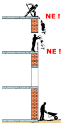
Obr.31: Shazování předmětů (převzato od Skanska) [3]
