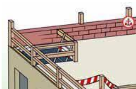
Obr.26: Zajištění otvoru (převzato od Skanska) [3]
