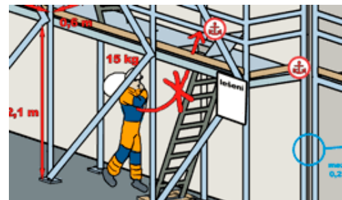
Obr.41: Vynášení nadrozměrných předmětů (převzato od Skanska) [3]
