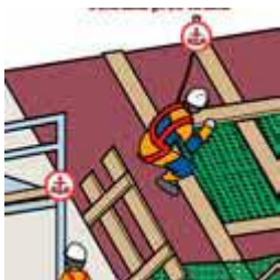
Obr.33: Lanový systém (převzato od Skanska) [3]
