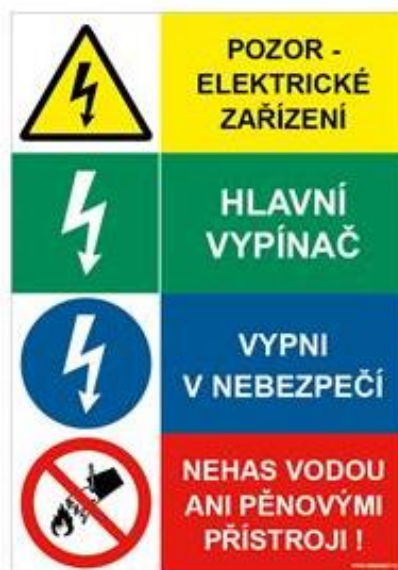
Obr.17: Označení hlavního vypínače [5]
