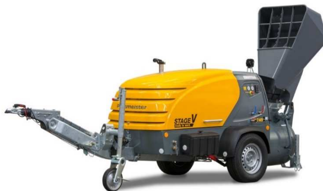
Obrázek 8 – Čerpadlo na beton Putzmeister Mixokret M 740 DHB
