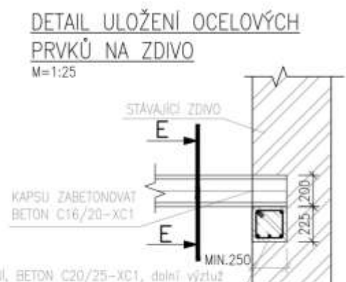
Obrázek 12 Výřez z výkresu Detail uložení nad sanovanou trhlinou
