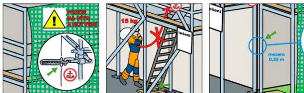
Obr. 20– Zľava kotvenie lešenia, výstup na lešenie, voľná medzera [50]
