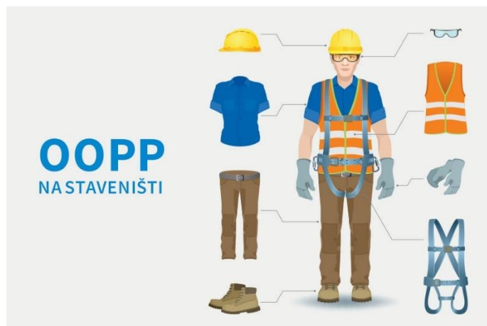
Obr. 2 – OOPP na stavenisku [19]
